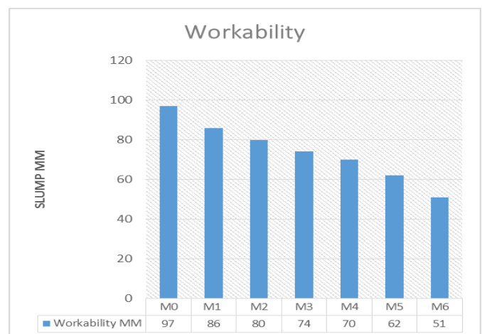
Fig -1: SLUMP CONE TEST
