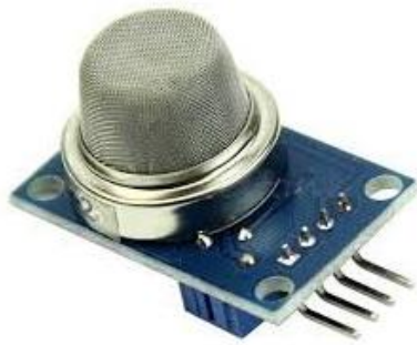
Fig:3 Gas Sensor
