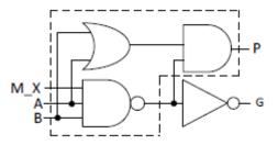
Fig. 3. A carry-maskable half adder.
