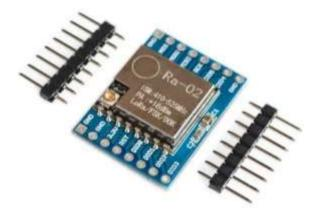
Fig-6: LoRa SX1278 Ra-02 module
