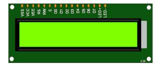
Fig-8: 16x2 LCD display
