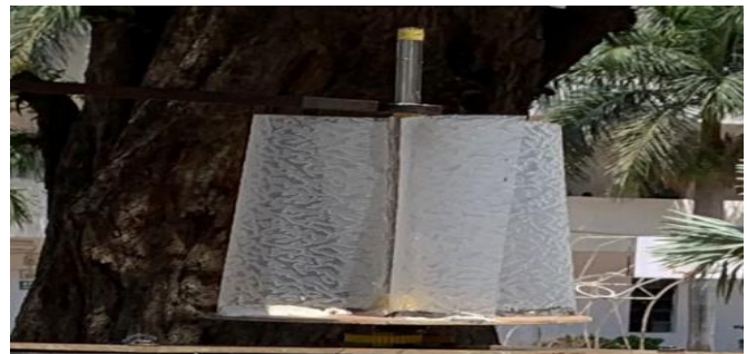
fig: 3.1.3 – wind turbine
