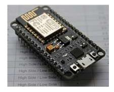
Fig: 4 Node MCU ESP8266
