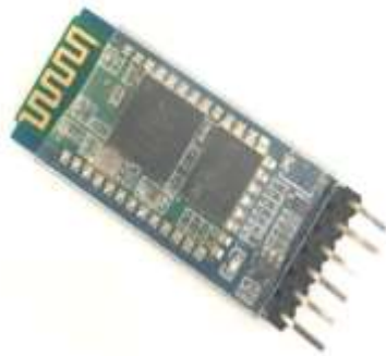
Fig -1: Bluetooth Module HC 05
