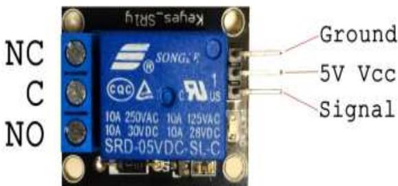
Fig. 5. Relay Pinout
