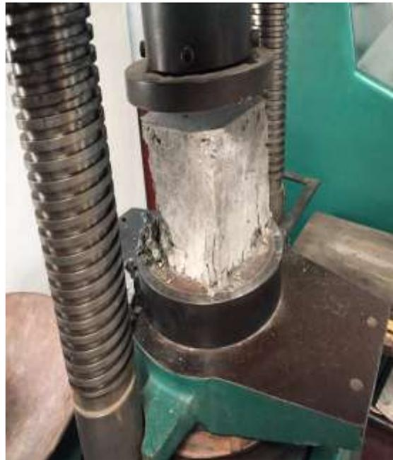
Fig.3 Split Tensile Test Setup
