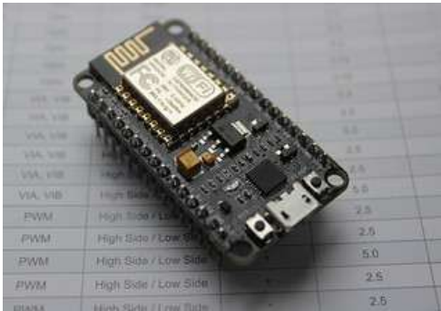
Fig -1: ESP 8266 Wi-Fi module
