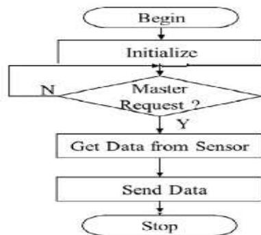
Fig-7. Flowchart of Sensor Node.
