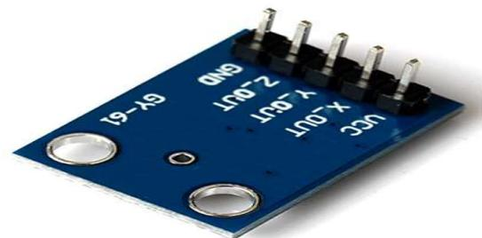
Fig -3 Accelerometer
