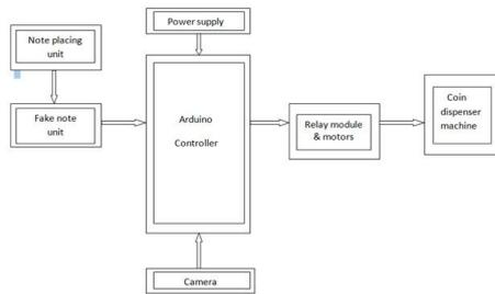
Fig. 2. Block diagram
