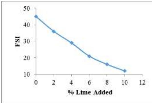
Fig. 1 FSI vs %lime
