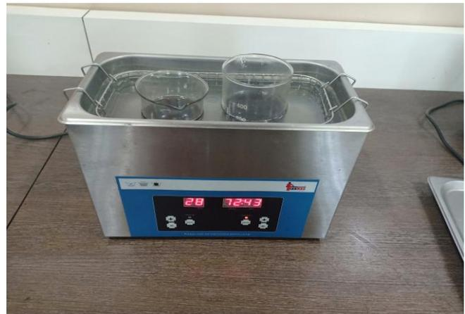
Fig.3- Ultrasonic Agitator
