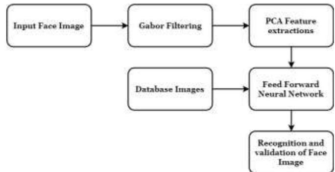
**Fig1. BLOCK DIAGRAM OF FACE RECOGNITION**
