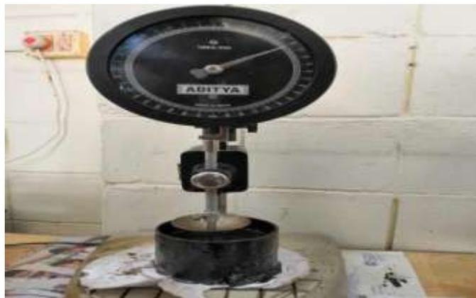
**Figure – 4:** Penetrometer
