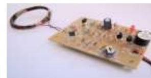
Fig-6. Metal Detector
