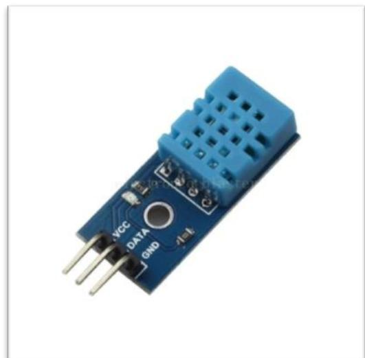
Fig4. DHT11 Sensor
