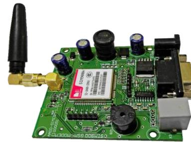
Fig-4: GSM module
