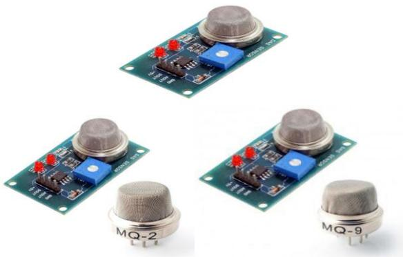
Fig:1.4: MQ2, MQ9, MQ3 GAS SENSORS
