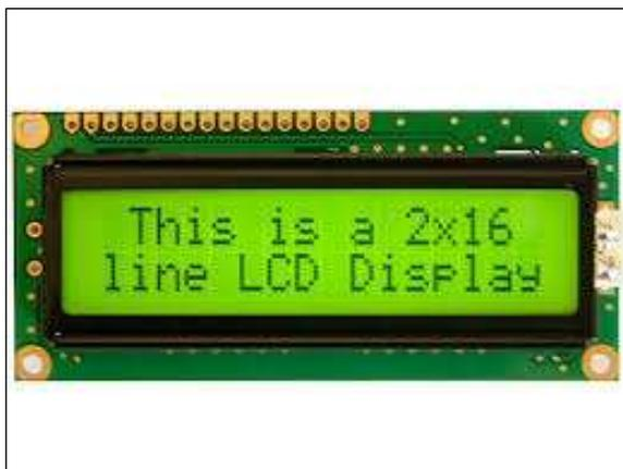
Fig. 2. LCD Display
