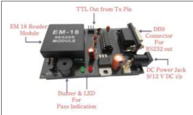
Fig.1. RFID Reader Module
