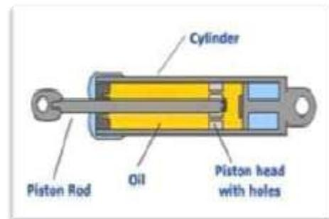
Fig: Viscous Damper
