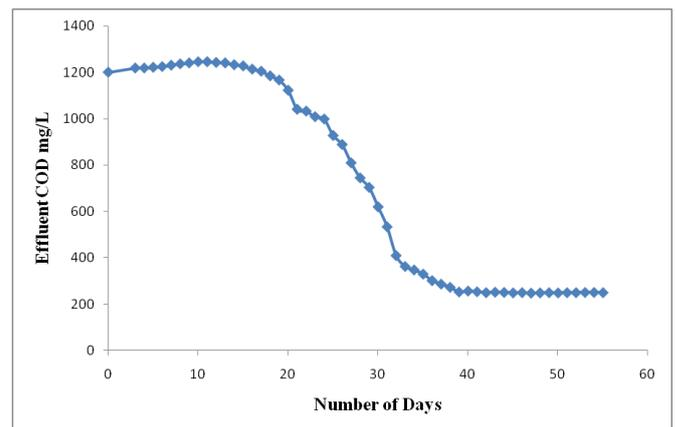
Fig. 2: Effluent COD per day
