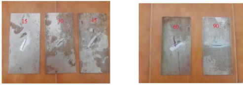
Fig - 2: 15°, 30°, 45°, 60° and 90° inclined crack
