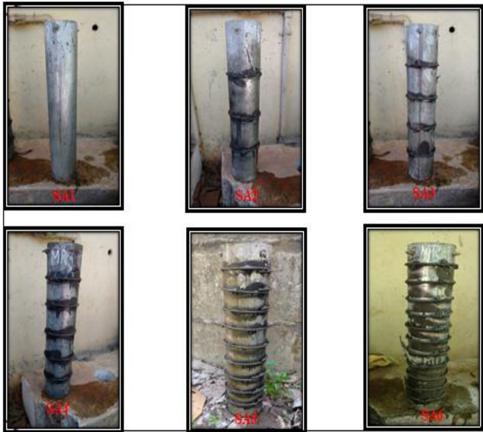
Fig -2: Different arrangement of steel rings in CFDSAT: (a) SA1 (b) SA2 (c) SA3 (d) SA4 (e) SA5 (d) SA6
