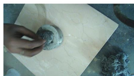
FIG 4.1. MINI SLUMP CONE TEST
