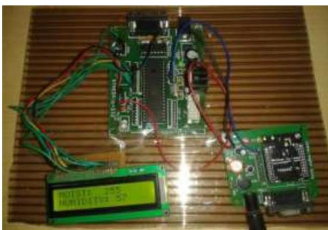
**FIGURE6: RECIVER SIDE PROTOTYPE**
