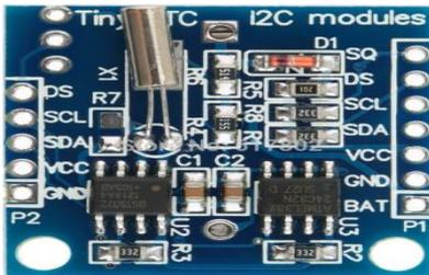
FIGURE 2: RTC MODULE
