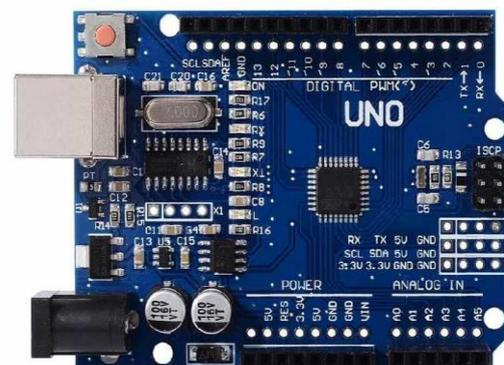
Figure 1: Arduino UNO module
