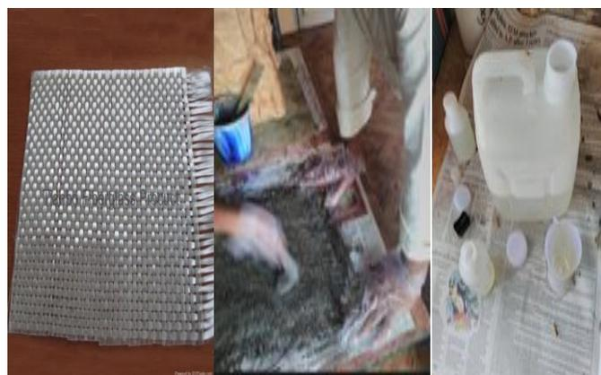
Fig:1 a) GFRP Mat b) Hand lay-up c) Epoxy resin
