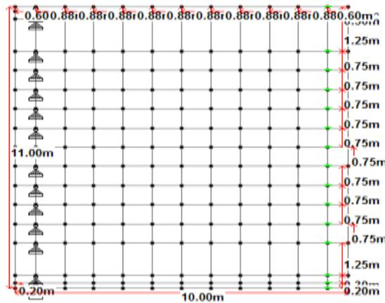
**Figure5: Deck slab grillage model**
