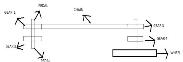
(FIG. 2.3.1 SHOWS WORKING OF DRIVETRAIN)
