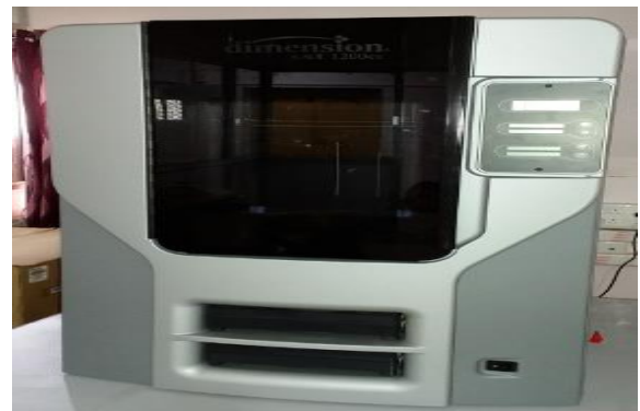
Fig. 2 STRATASYS dimension 1200 es F.D.M machine
