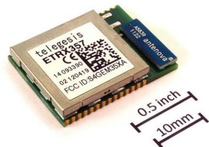
Fig-5 Zigbee module
