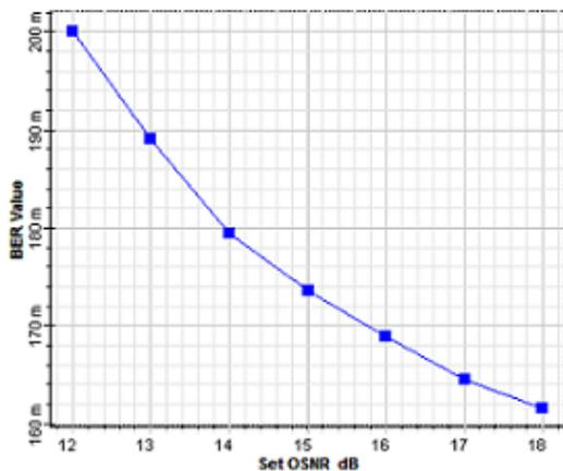
Fig. 4(d) Gaussian filter 3<sup>rd</sup> order Before CPE
