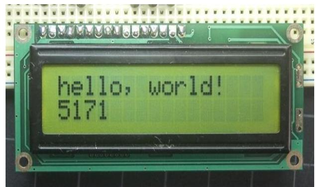
Fig-4 : LCD Display
