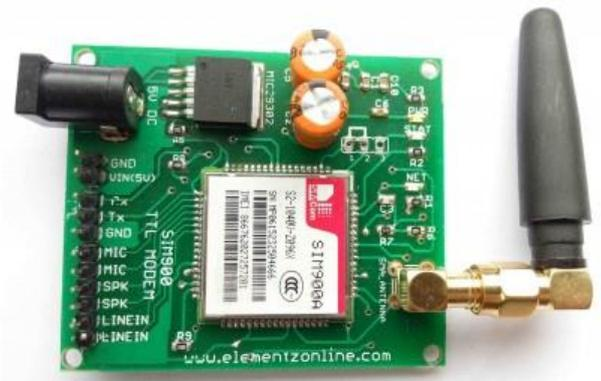
Fig. 2. SIM 900 GSM
