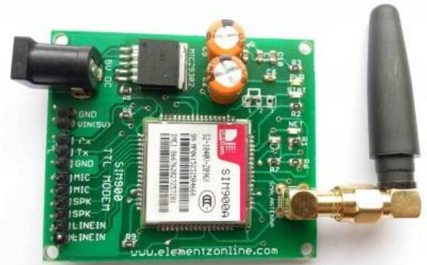
Fig. 2. SIM 900 GSM
