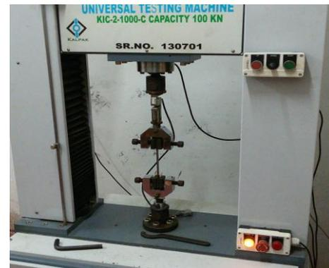
**Fig -1: UTM Tensile load Test**
