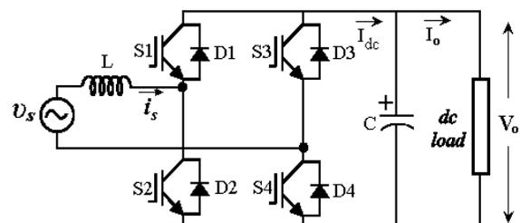
Fig -2: Single-phase PWM rectifier
