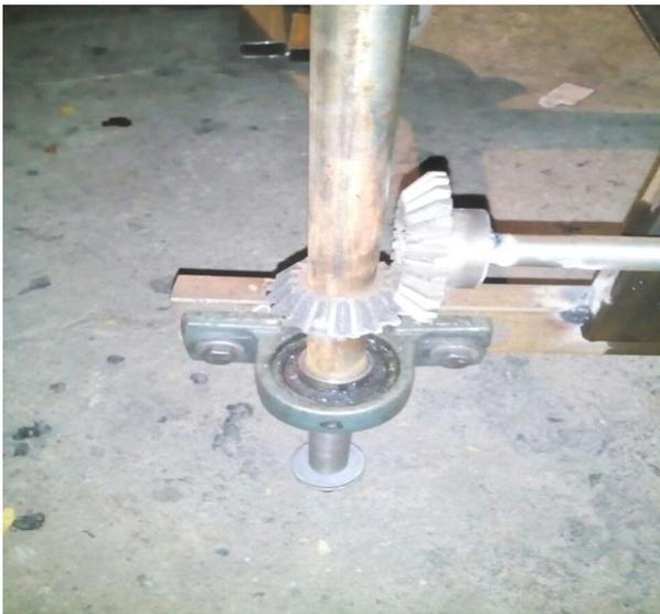
**Fig. BEVEL GEAR**
