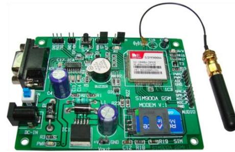
Fig -4: GSM module
