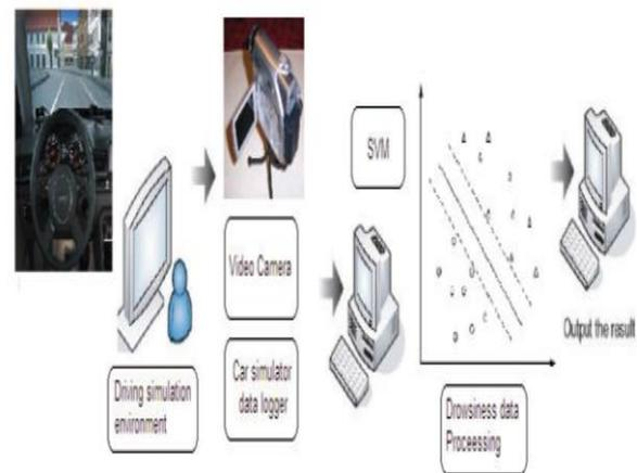
**Fig:1 Research Test-Bed System Components**
