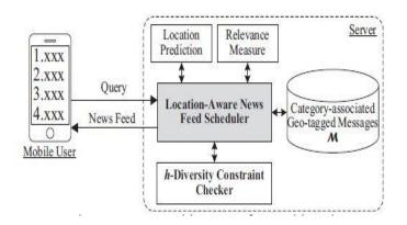
Fig. 3: System Architecture D-Mobifeed System
