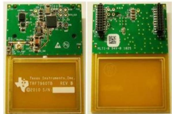
**FIGURE 2-** NFC module TRF7970ATB
