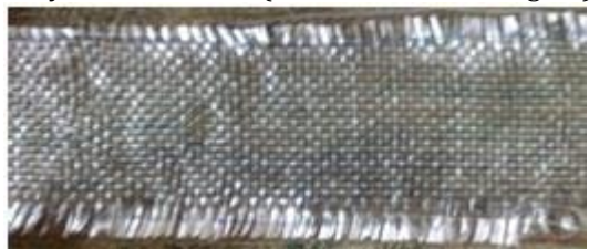
5 layer GFRP (Bi-directional)
