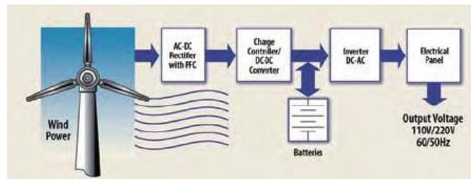
Fig. 1. WIND ENERGY GENERATING SYSTEM
