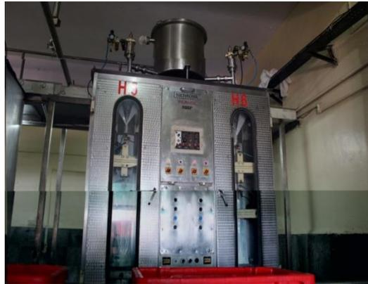
**Fig no 3 : Pasteurization machine**
