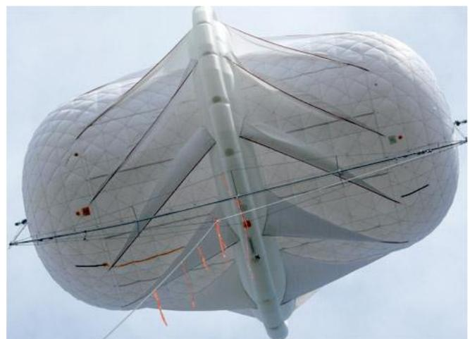
Fig -1: Magenn Air Rotor System
