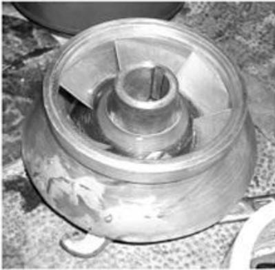
**FIGURE-6 THE PUMP ROTOR PROTOTYPE USING RAPID PROTOTYPING TECHNOLOGY**
