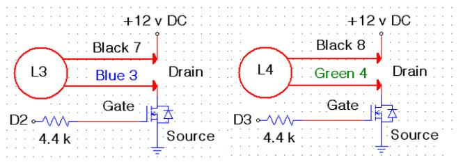
Figure: 8.4 (c) MOSFET ckt - III      Figure: 8.5 (d) MOSFET ckt - IV
